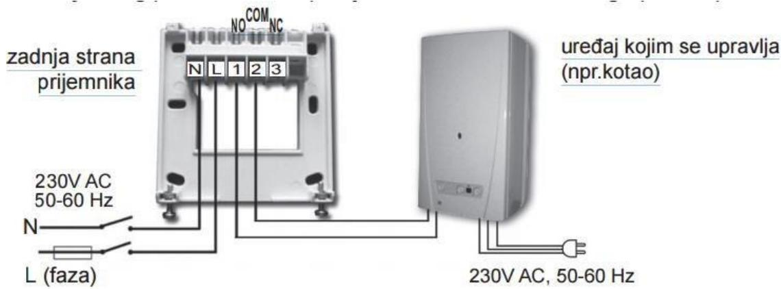
Na priključnom kabelu određenog aparata potrebno je presjeći 0-ti vod ili fazu, pa presječeni vod spojiti na točke 1 i 2 prijemne jedinice.
