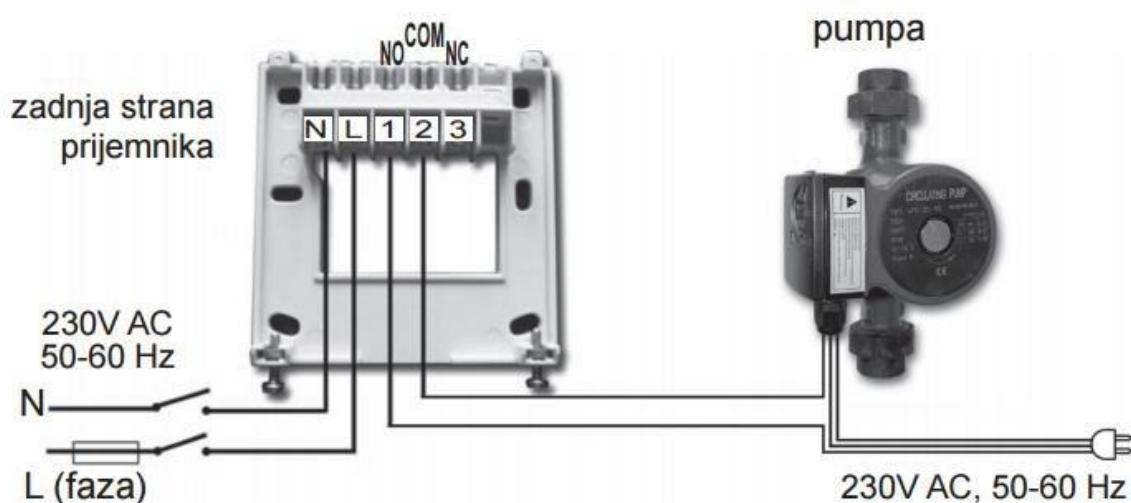
Duljina voda je nebitna. Prijemna jedinica se može montirati pored kotla (ni u kom slučaju ispod kućišta) ili na većoj udaljenosti od njega. Ako zbog nekih razloga udaljenost između prijemne jedinice i termostata suviše velika, a to uzrokuje da radio frekvencijska veza postaje nesigurna, prijemnu jedinicu treba montirati bliže termostatu.
